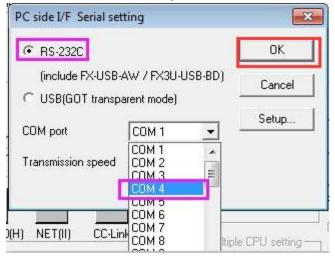
8、完所 COM 选择后,点击【Connection test】按钮,弹出通信成功后,点击【OK】。如下图所示:
