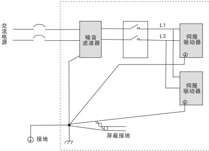
图 4.16 噪音滤波器地线处理示意图
